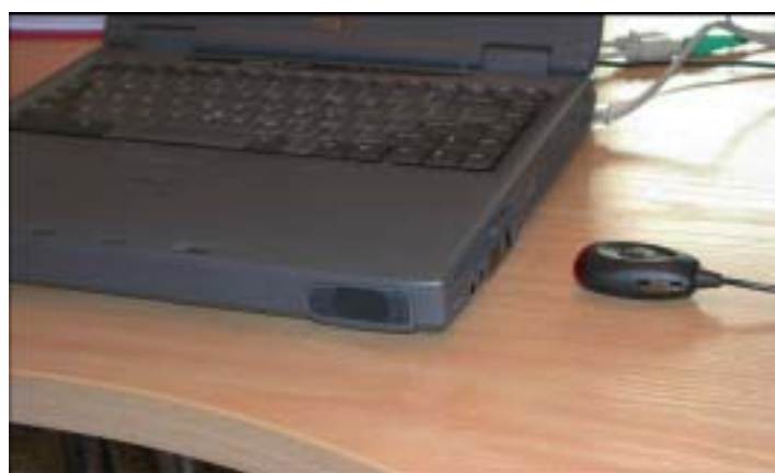
Rys.2 Przykład podłączenia telefonu komórkowego bądź PC za pomocą IrDA z laptopem
