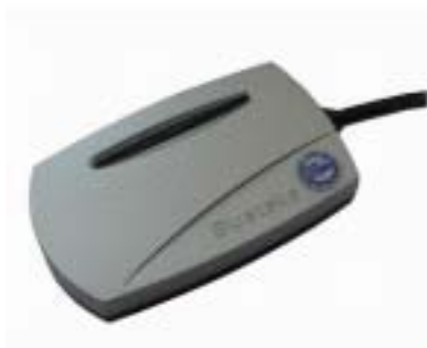
Rys.6 Kontroler umożliwia przesłanie danych na odległość do 100 metrów przy przepustowości do 1 Mbit/s.
