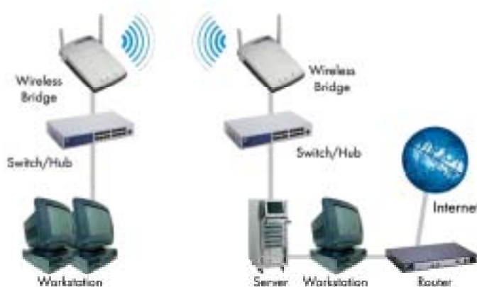
Rys.10 Połączenie dwóch odrębnych podsieci, w tym przypadku są to sieci przewodowe. W celu polepszenia jakości transmisji stosuje się zamiast małych anten przystosowanych do transmisji wewnątrz budynku na zewnętrzne anteny kierunkowe. Możemy w ten sposób połączyć np. dwa budynki.
