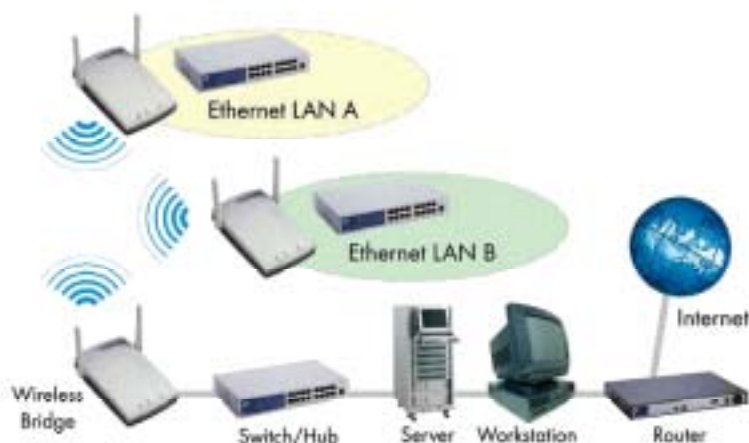
Rys. 11 Tak schematycznie wyglądają trzy klasyczne (kablowe) sieci lokalne połączone łączem bezprzewodowym.
