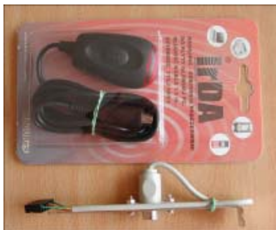
Rys.1 IrDA z 1,5 m kabelkiem i śledziem
